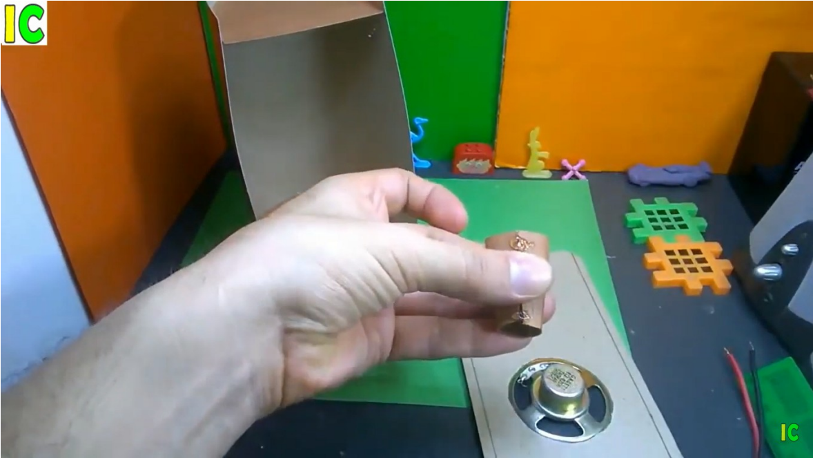
lo pegamos con silicón y esta parte le da mejor resonancia a nuestro altavoz
