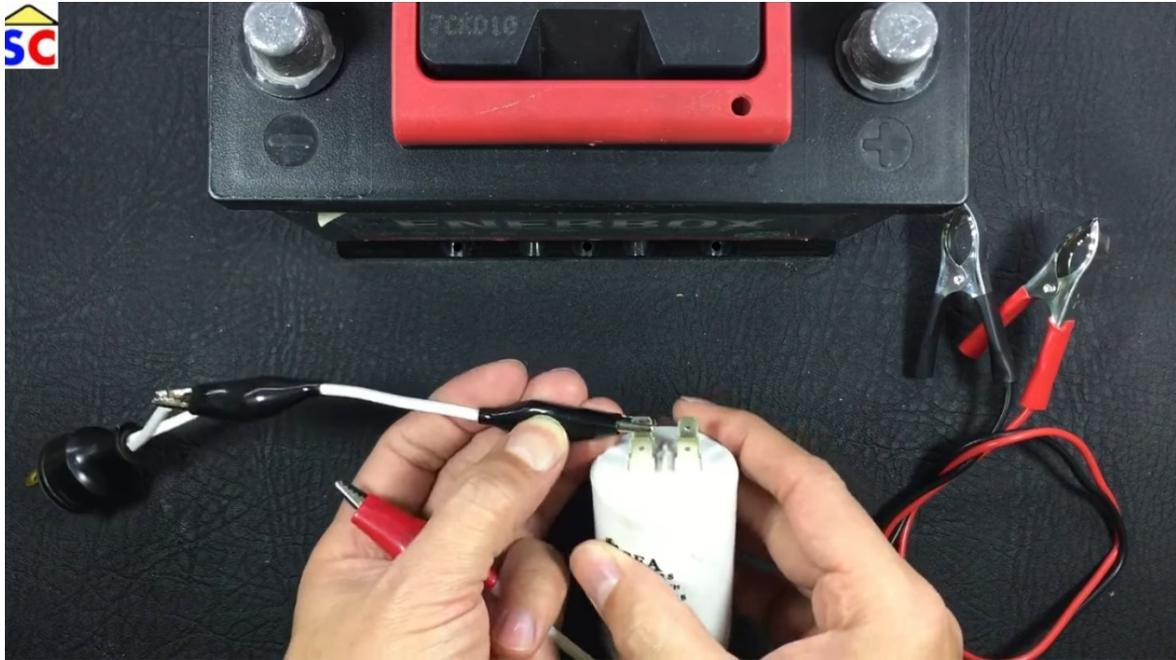
Lo primero que vamos a hacer es conectar un cable que viene del enchufe con una entrada del capacitor esa es la primera conexión
