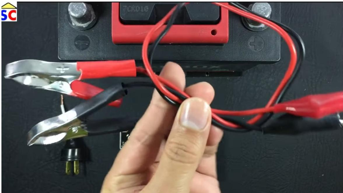
Y los cables para hacer las conexiones a la batería
