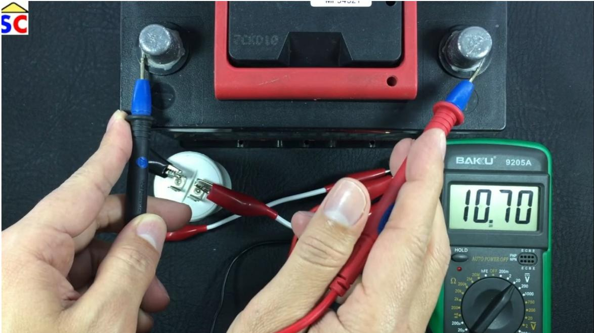
Nos marca 10.70 voltios está muy por debajo de 12, podría decir que es una batería dañada, en este momento lo conectamos y mediremos el voltaje y la corriente que fluiría de este recuperador o cargador de batería a la batería.
