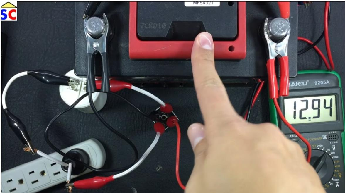
Tenía inicialmente 10.66 voltios, eso quiere decir que la batería es totalmente recuperable pero una batería que este por debajo de ese valor ya es bastante difícil recuperarla con cualquier cargador que se le coloque entonces no funcionara ya que si está en 0 voltios seguramente tiene otro tipo de problema.
