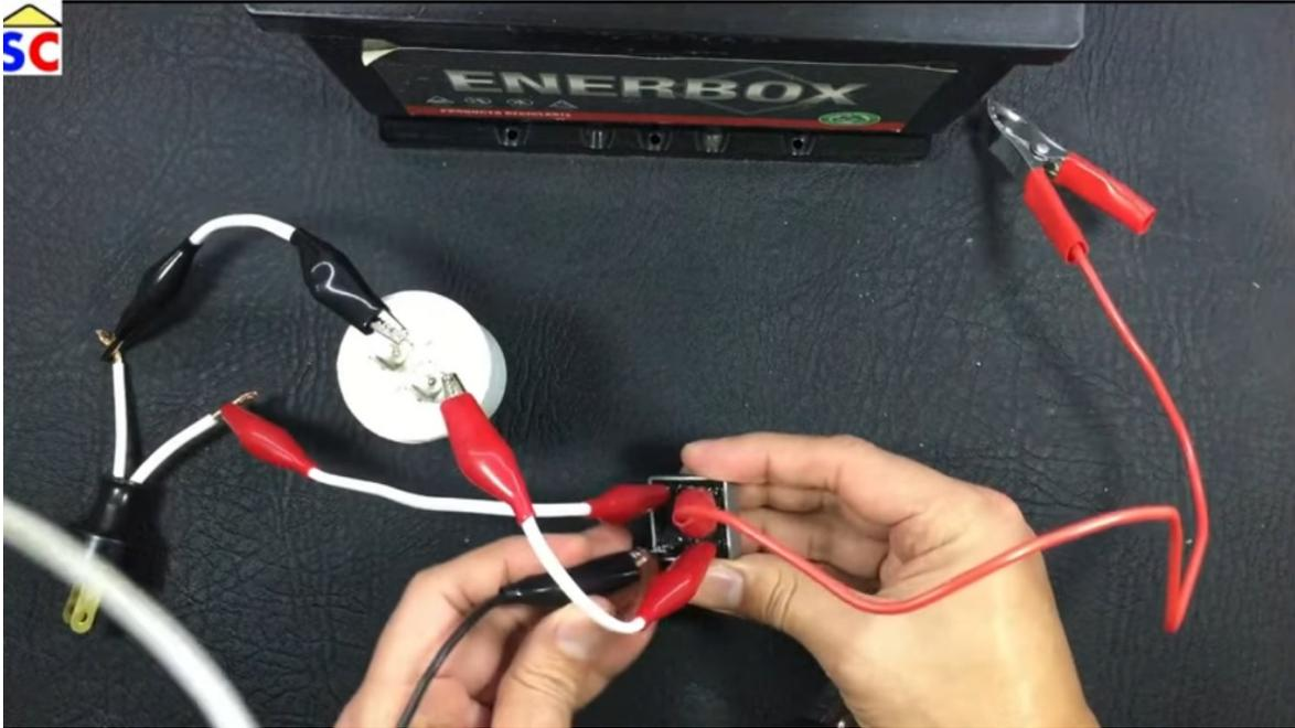
Que es el borne positivo de la batería y el otro que nos queda es el cable negro que va hacia el borne negativo de la batería.
