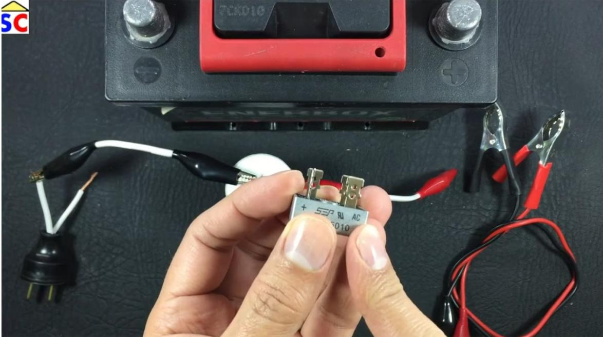
Luego ubicamos la corriente alterna, por lo que una de las entradas de AC se va a conectar con este capacitor y luego el otro extremo que viene del enchufe va a ir a la otra parte de la entrada AC del puente de diodos, como lo puedes ver en la imagen.
