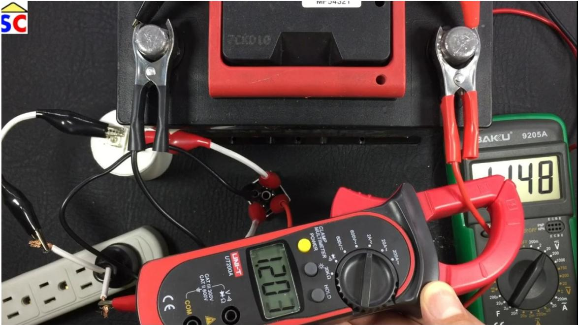
Fíjate que con un menor rango me da mayor precisión que son 1.2 amperios circulando por ese recuperador o cargador de batería hacia la batería.
